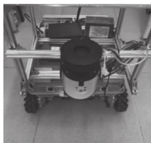
图1 激光雷达与移动平台
